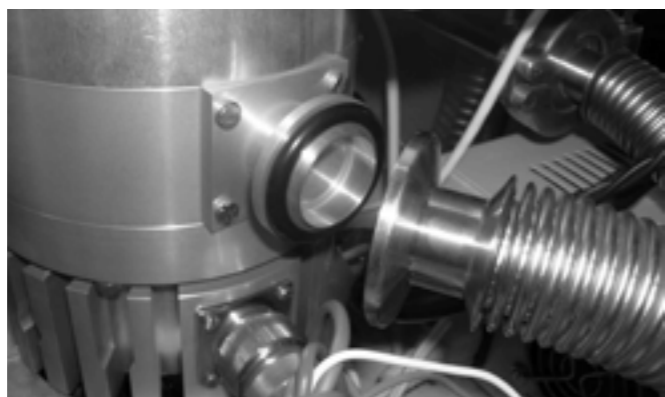
图 3-18 分子泵前级口放气
