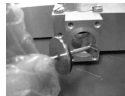
图 3-9 取出全离子检测极
