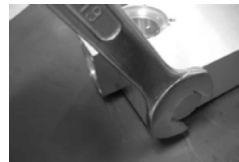
图 3-12 松动堵头螺钉
