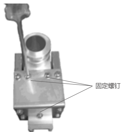
图 3-3 取下固定螺钉
