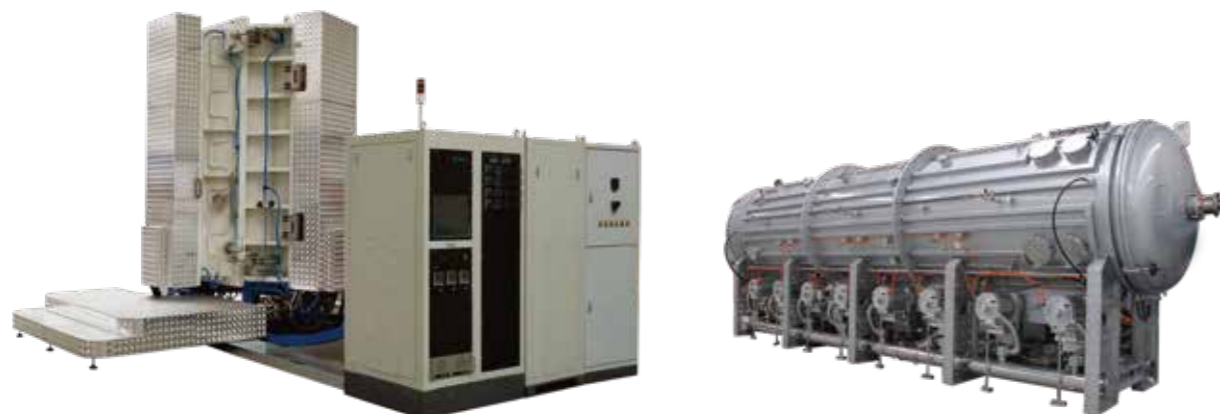
中高温集热管镀膜设备 HCE Tube Coating System For CSP
